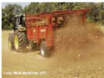
Photo: M. U. Meißner 2005 Ausbringung von Grünmühsackel mit senkrecht stehenden Streuwalzen am Miststreuer
