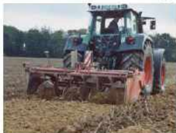
Mischende Tiefenlockerung des Bodens mit einer Spatenmaschine bis auf 85 cm Tiefe zur Infiltrationsfördernden Tonanreicherung im Oberboden
