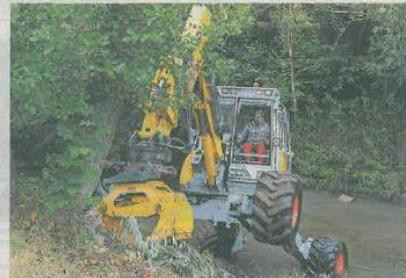
Jedes der vier Räder des Schreitbaggers kann einzeln gesteuert werden. Dadurch verringert sich der Schaden, den das schwere Gerät an der Uferböschung anrichtet. Foto: Stefanie Jani
