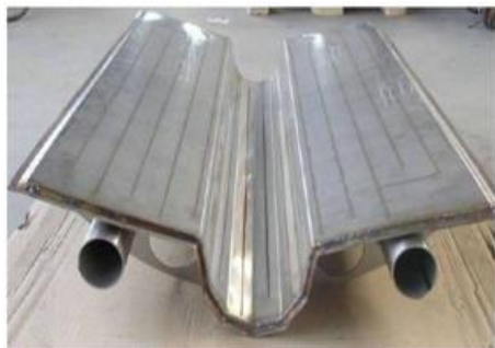
Rinnenwärmetauscher Fa. Uhrig
