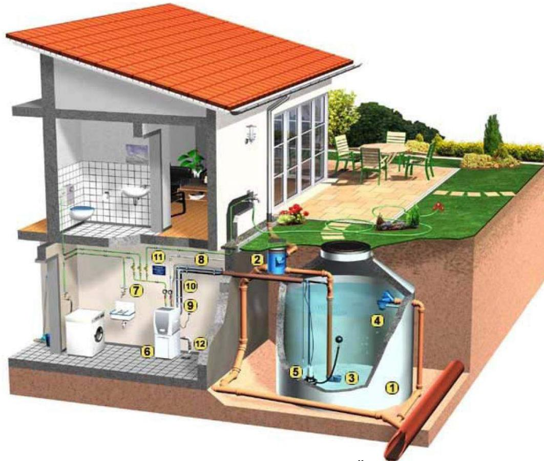
(1 – Regenwasserspeicher, 2 – Filter, 3 – beruhigter Zulauf, 4 – Der Überlauf, 5 – Die Pumpe, 6 – Die Anlagensteuerung, 7 – Die Betriebswasserleitung, 8 - Kabelkanal für Sensor und Pumpenkanal, 9 – Druckleitung, 10 - Nachspeiseleitung von der Ladepumpe, 11 – Trinkwasserleitung für Nachspeisung, 12 - Überlauf)
