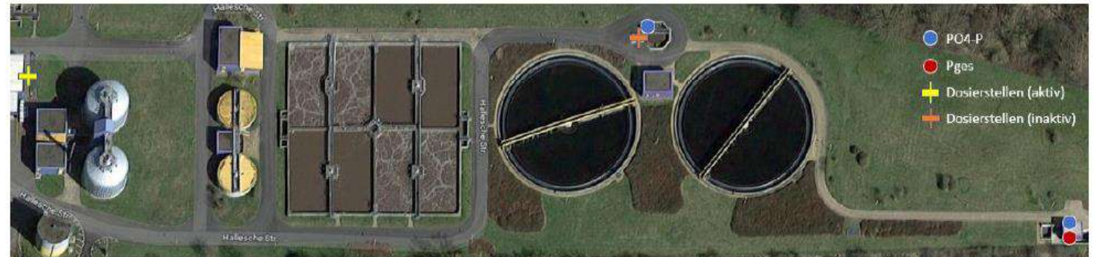
Bild 1: Aktuelle Dosier- und Messstellen
