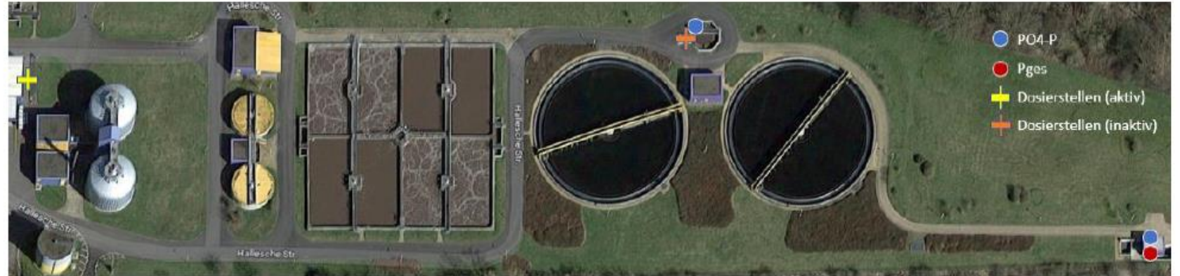
Bild 1: Aktuelle Dosier- und Messstellen
