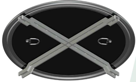
Dieser Havarieverchluss ist für den kurzzeitigen, vollständigen Verschluss des Kanalschachtes ausgelegt, um ihn bei Starkregen, Schmelz- und Hochwasser vor übermäßigem Oberflächenwasserzufluss zu schützen. Die Stabile Konstruktion hält einer Überstauhöhe von bis 5,0 m über dem Straßenniveau stand und hat eine abrutschsichere Randschichtung. Der Einbau erfolgt besonders schnell. Den Ausbau erleichtern Griffaschen, die zur Reduzierung der Bauhöhe klappbar sind.
