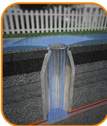
Lüftungsöffnungen des Schachtdeckels in das Abwassernetz einfließen. Dieses Oberflächenfremdwasser belastet Kläranlagen und führt zu erhöhten Abwasserabgaben.
