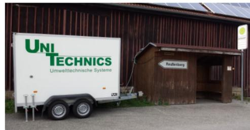
Durch den Einsatz dieses mobilen Dosieranhängers können Sie eine Dosierung von Nitraten oder Fällmitteln an einem Kanalabschnitt, Pumpwerk oder einer Kläranlage testen.
