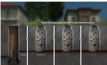
Vor dem Einsatz von Geruchsdämpfungs-Systemen werden H<sub>2</sub>S-Messungen durchgeführt, um zu ermitteln, wie hoch die Geruch und Korrosion auslösende Sulfidfracht im Abwasser und wie weit die Ausgasungstrecke nach einer Druckrohrleitung ist.
