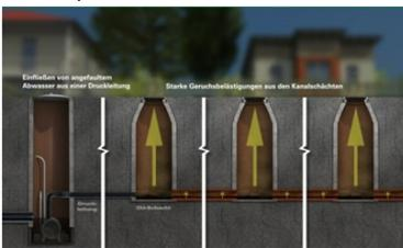
Sogenannte Thiobazillen Stoffwechseln den aufoxidierten Schwefel und scheiden Schwefelsäure aus. Das führt unweigerlich zu biogener Schwefelsäurekorrosion, die bauliche Anlagen und technische Einrichtungen in ihrem Bestand gefährdet, s. Abb:
