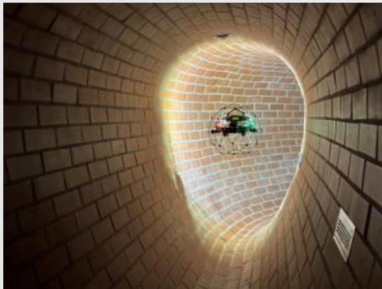
„DIANE“ („Drohneinsatz zur Inspektion von Abwassernetzen“) ist ein aktuelles UNITECHNICS-Forschungsprojekt.
