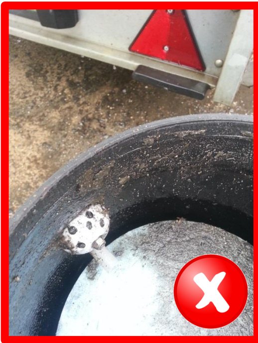
Ablauföffnung innen verstopft
