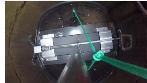
8. Hebel der Spannvorrichtung mit Hilfe der Bedienstange herunter drücken
