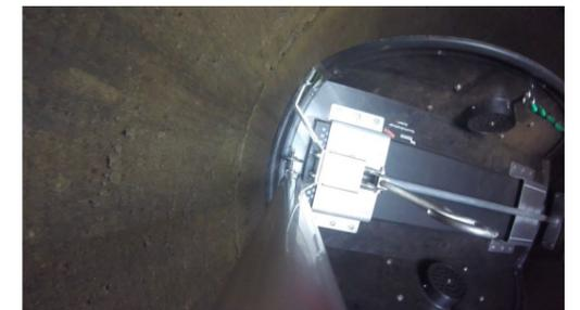
6. System an dem Seil in die Schräglage bringen, bis die eine Seite des Systems an der Schachtwand anliegt
