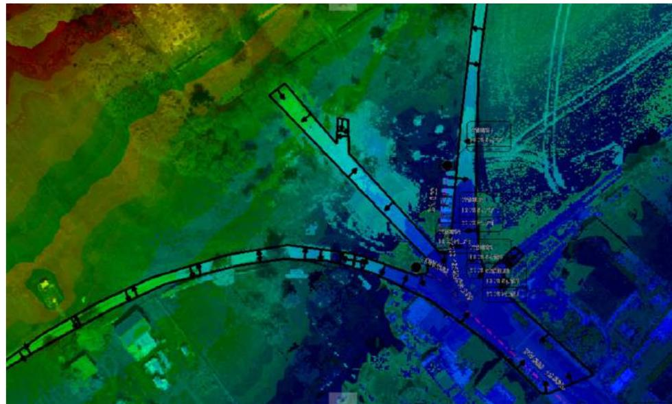
Umsetzung in Kanal++ mit Bruchkanten an den versiegelten Flächen
