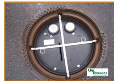
WaterCounter WaCo-3 (li.) und im Schacht eingebaut (unten)
